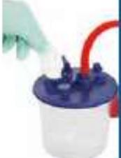
**4** Desconecte el tubo rojo de vacío del puerto de vacío y tápelo con su tapón.
